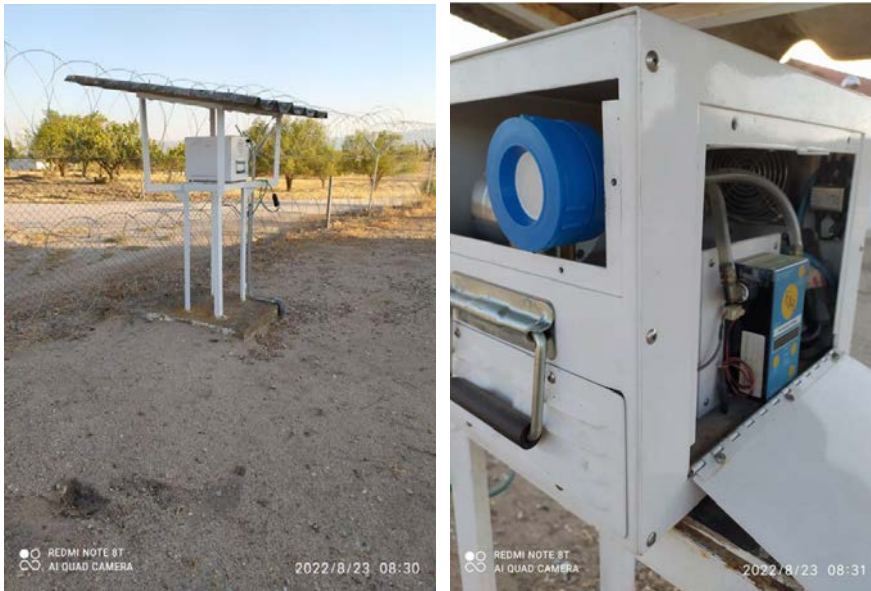
Estación de muestreo del PVRA y muestreador de radioyodos de Almaraz
