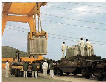
Preparación de la expedición del combustible irradiado
