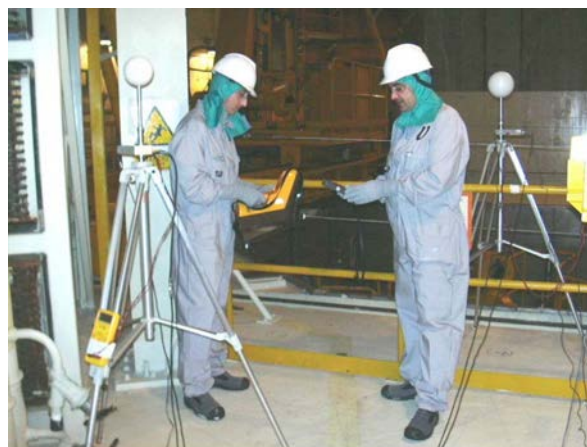
Recinto de Contención. Medidas neutrónicas mediante esferas Bonner
