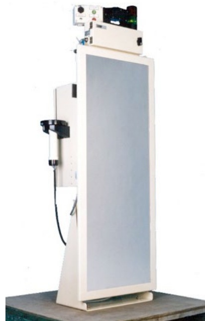
Ejemplo baliza gamma instalada en Cofrentes
