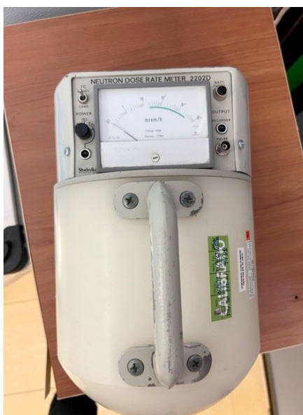
Equipos de mediada de neutrones STUDVICK y DINEUTRON
