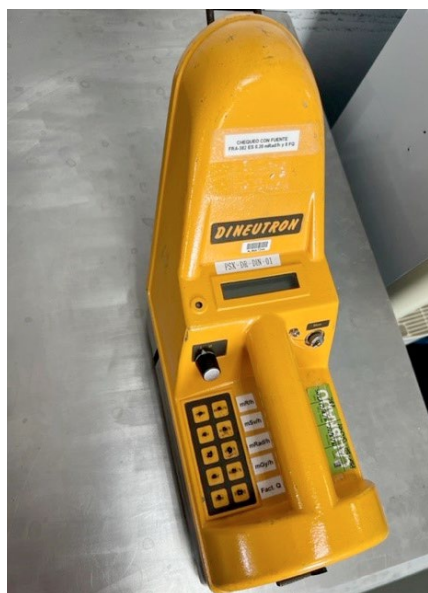
Equipos de mediada de neutrones STUDVICK y DINEUTRON
