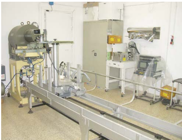
Blindaje contenedor de las fuentes tipo revolver
