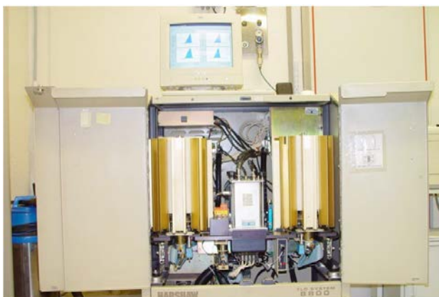
Sistema de termoluminiscencia
