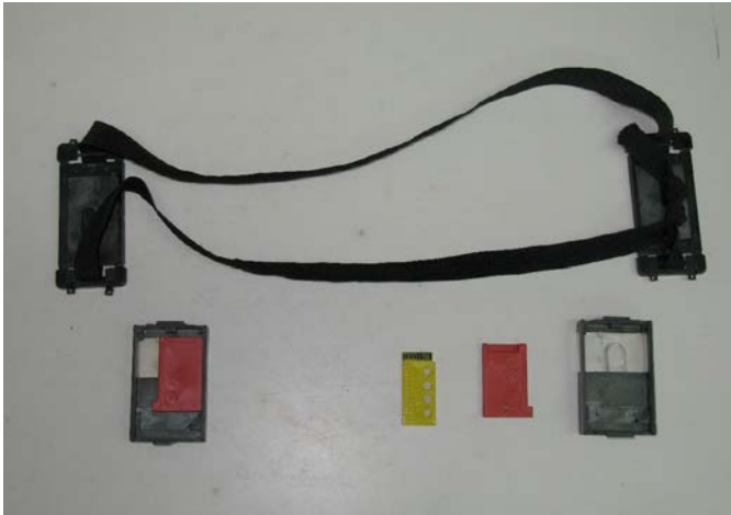
Dosímetro Albedo usado en Almaraz
