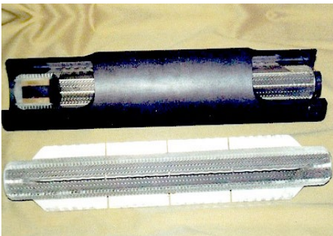
Elemento combustible y detalle del estribo
