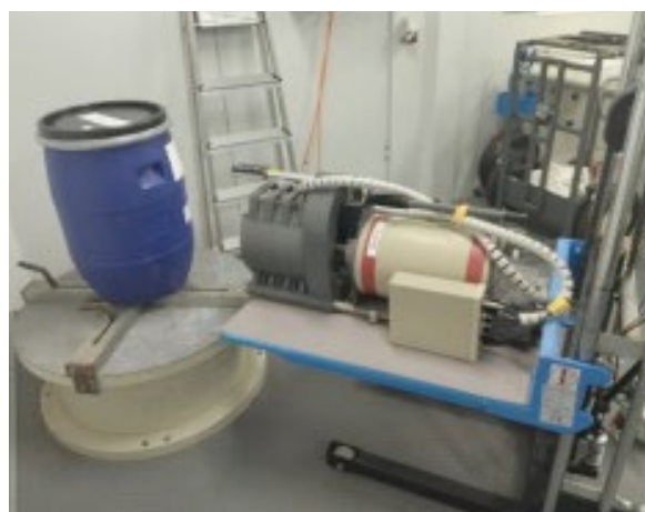
ISOC's para la medida de residuos en contenedores CMT y en bidones
