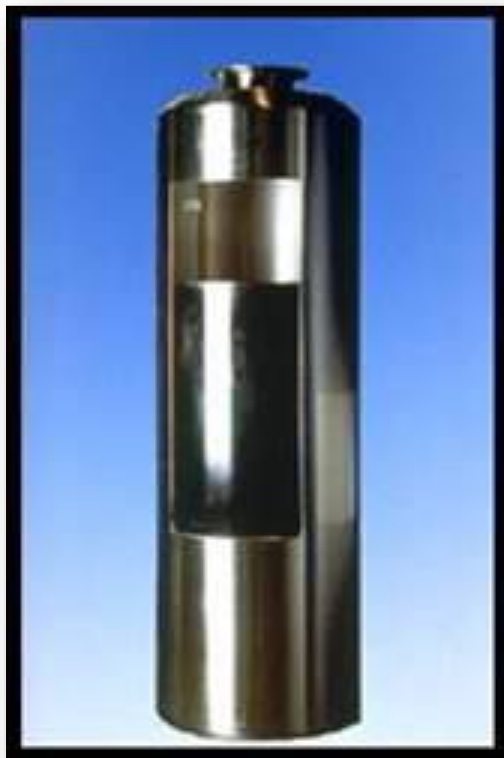
Cápsula de acero que contiene en su interior una matriz de vidrio con residuos de alta actividad (dimensión típica: 1.6 m de alto)
